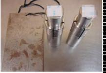
←左が「ポントテープWF751(コシ)」。右が某社の「強力」を謳っている両面テープ。よく脱脂して貼り付け
